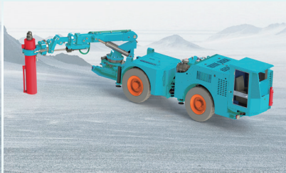
液压立柱更换
