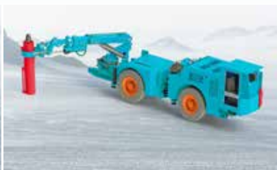
液压立柱更换
